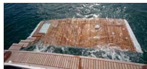
L'accès à la plate-forme hydraulique est facilité par les cinq échelons intégrés.
